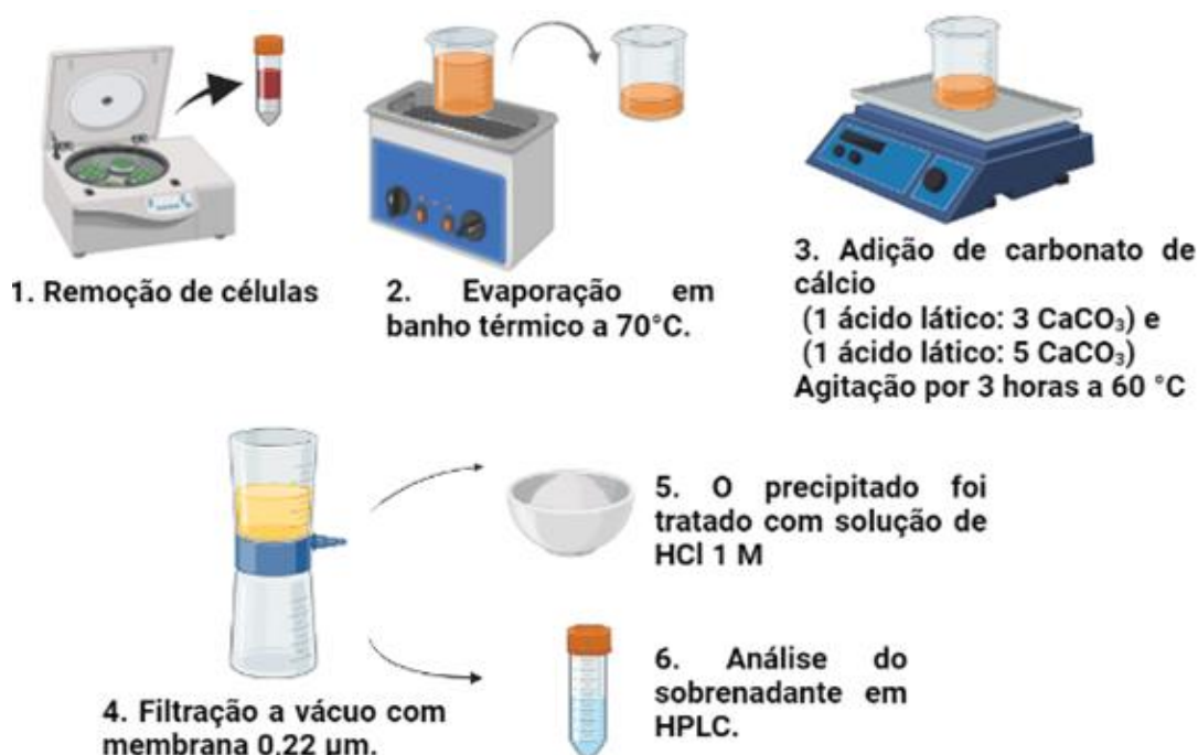
Figura 14 – Etapas de purificação do ácido láctico com carbonato de cálcio.
