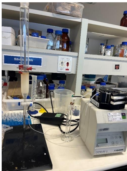
Figura 16 - Equipamentos utilizados para os experimentos de troca iônica. Coluna de vidro com membrana de vidro para retenção da resina acoplada a bomba peristáltica.
