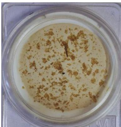
Figura 39 - Fotografia da membrana com material resultante após separação por densidade com NaI ( $1,6 \text{ g/cm}^3$ ).
