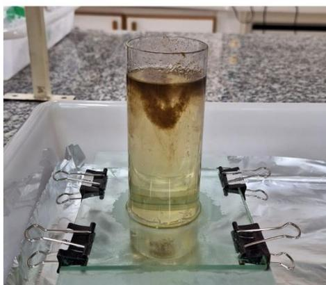
Figura 36 - Fotos das amostras após 14 dias em contato com a solução de NaI ( $1,6 \text{ g/cm}^3$ ) para separação por densidade mostrando que não houve separação significativa.
