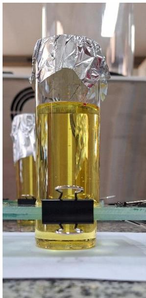
Figura 24 - Fotografia do sistema JAMMS durante separação por densidade com NaI ( $1,6 \text{ g/cm}^3$ ).
