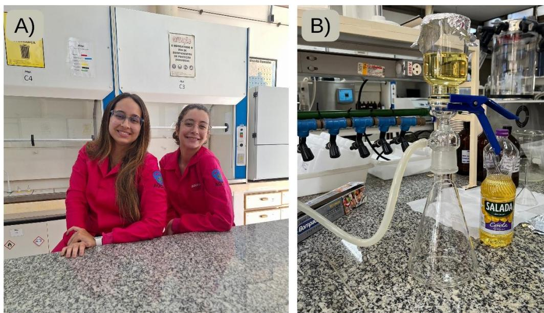
Figura 28 - a) Foto das analistas com jaleco de algodão cor de rosa utilizado durante as análises das amostras; b) Imagem da filtração do óleo utilizado no presente trabalho a fim de eliminar possíveis contaminações de microplásticos.
