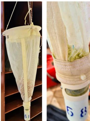
Figura 8 - Fotos da rede de plâncton utilizada na amostragem. a) rede de coleta b) copo amostrador.
