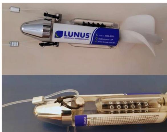
Figura 15 - Fotografias do fluxômetro mecânico 2030BR (LUNUS) utilizado.
