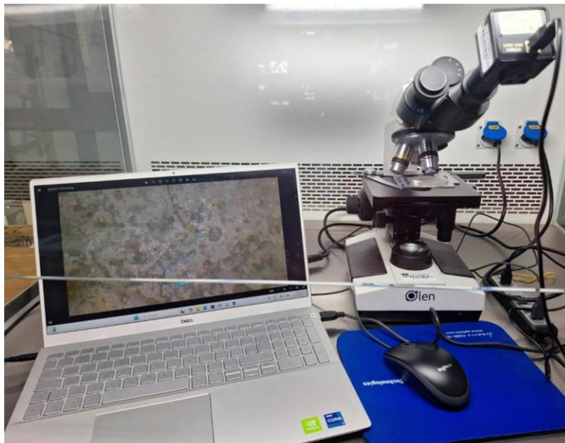
Figura 26 - Fotografia do microscópio utilizado para contagem dos microplásticos feita na capela de fluxo laminar.
