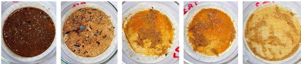
Figura 7 - Fotografias das membranas obtidas após preparo de amostra utilizando reação de Fenton e separação de densidade com solução salina de NaI ( $1,6 \text{ g/cm}^3$ ). Fonte: adaptado de Alves (2021).
