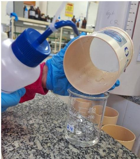
Figura 18 - Foto do momento de transferência da amostra coletada da peneira para um béquer de 250 ml com o auxílio de água ultrapura.
