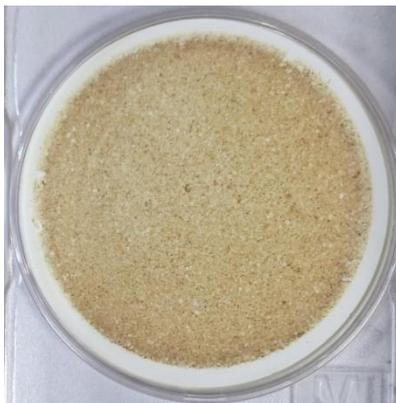
Figura 37 - Fotografia da membrana resultante após filtração da amostra digerida por Fenton.
