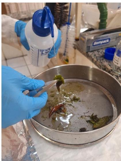
Figura 17 - Registro do peneiramento de uma amostra com peneira de aço inoxidável com abertura de 63  $\mu$ .
