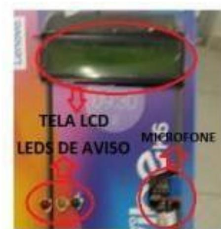
Figura 15: Primeira versão do protótipo construído em uma caixa de celulares antiga e ainda utilizando leds e uma tela de LCD- Brasília-DF, 2024.
