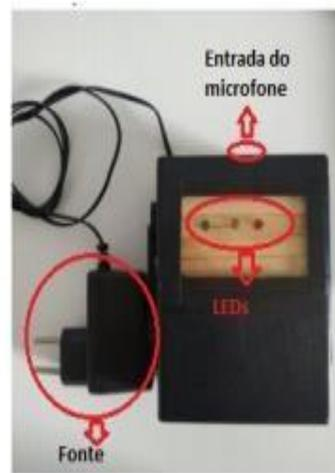
Figura 16: Protótipo versão 2, já sem a tela de LCD e a utilização de uma caixinha de plástico e com a presença da fonte. Brasília-DF, 2024.
