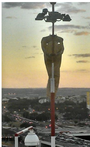
Figura 27 - Cone de vento danificado devido à exposição ao tempo além do previsto pela garantia
