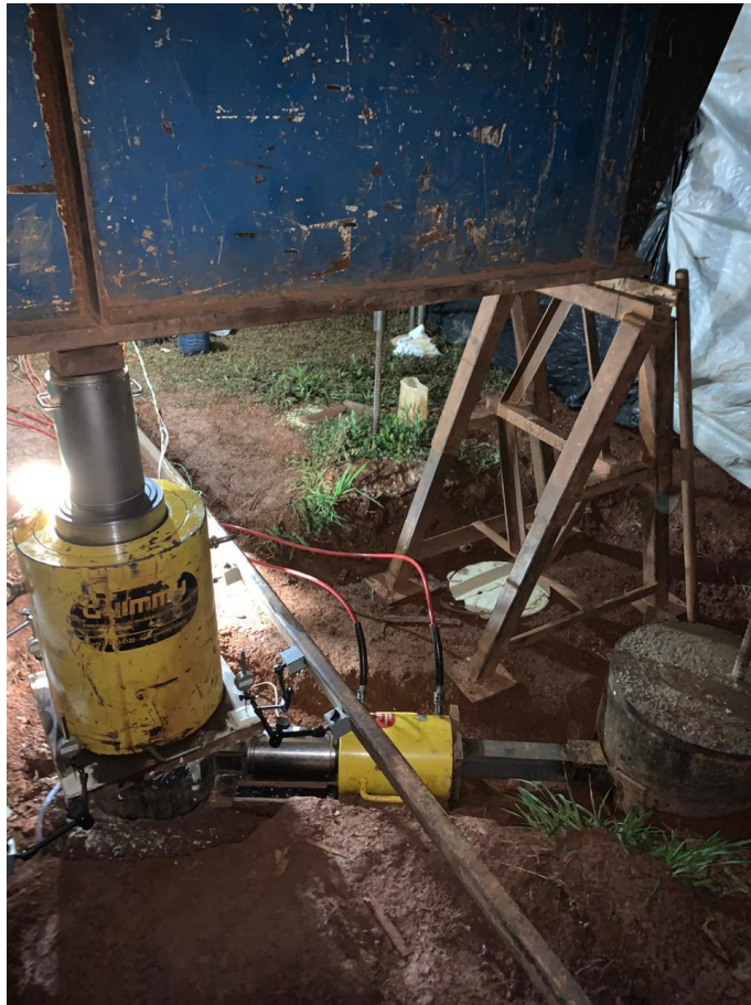
Figura 3.18 Execução do ensaio com carregamentos axial e transversal em T3.
