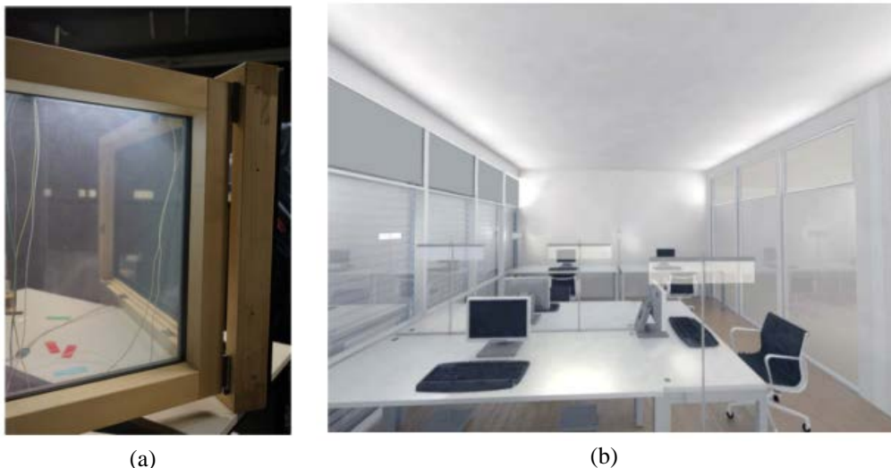
Figura 6 - Protótipo do sistema de microestruturas integrado com o sistema LED (a) e ambiente de escritório com guias de LED nas áreas superiores das janelas e das partições (b)
