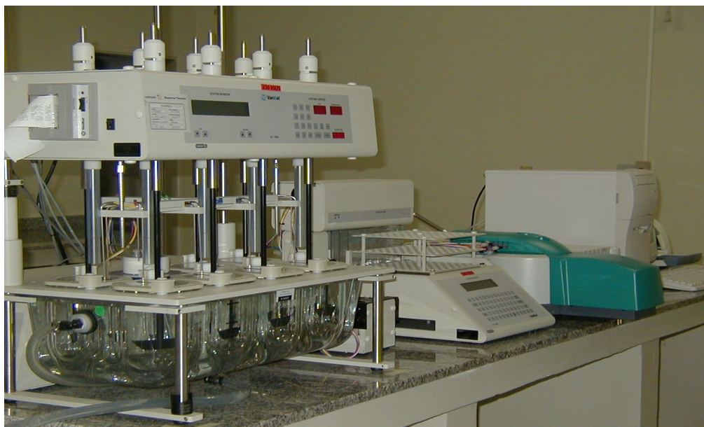
Figura 6 – Dissolutor Vankel 7000 acoplado espectrofotômetro UV Cary 50 (Varian), sistema total solution . Localização: Laboratório de Tecnologia Farmacêutica - FF/UFG.
