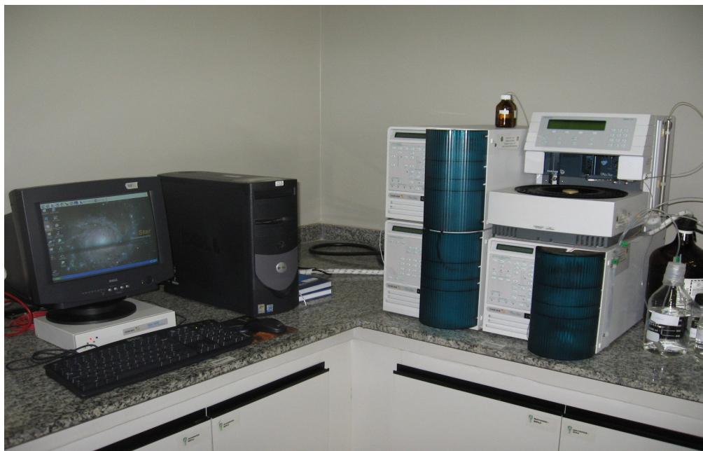
Figura 4 – Cromatógrafo Líquido de Alta Eficiência (Varian). Localização: Laboratório de Tecnologia Farmacêutica - FF/UFG.
