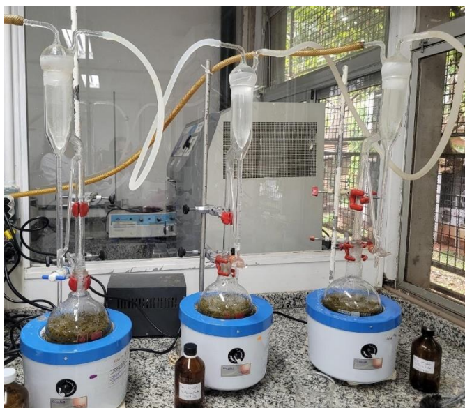
Figura 14. Aparelho tipo Clevenger modificado acoplado a um balão com manta de aquecimento.
