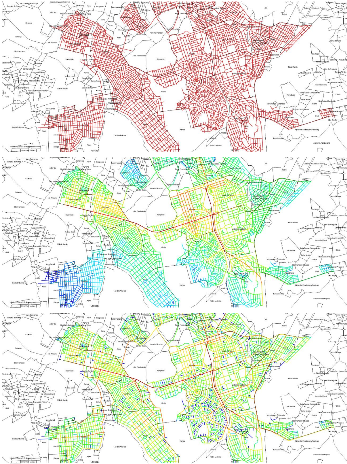
Figura 54 - Modelagem Configuracional do Sistema Urbano de Goiânia em 1951, com Sobreposição de Bairros Atuais: Representação Linear (em cima), Variável NAIN (centro) e Variável NACH (embaixo).
