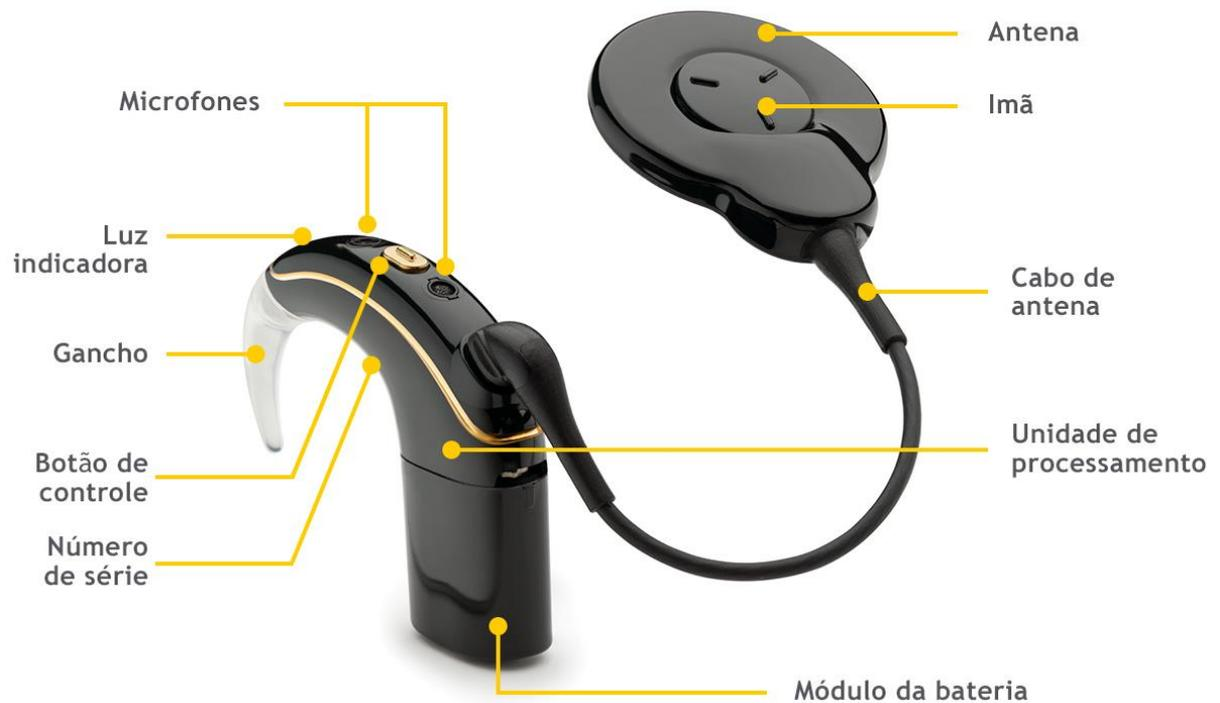
Figura 2. Processador de fala do Implante Coclear.
