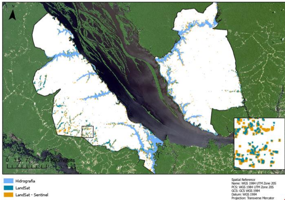
Figura 33 Comparação dos polígonos identificados utilizando os sensores Landsat e Sentinel.
