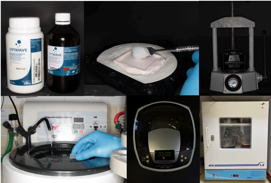
Figura 3. Representação das etapas do processo de fabricação das amostras de resina acrílica.
