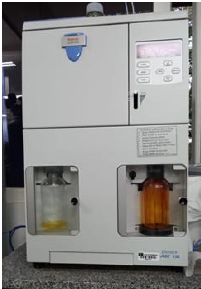
Figura 4.3. Equipamento de Extração Acelerada por Solvente – 150, utilizado para extração por solvente das sementes de urucum (ASE -150 - do inglês Accelerator Solvent Extractor )
