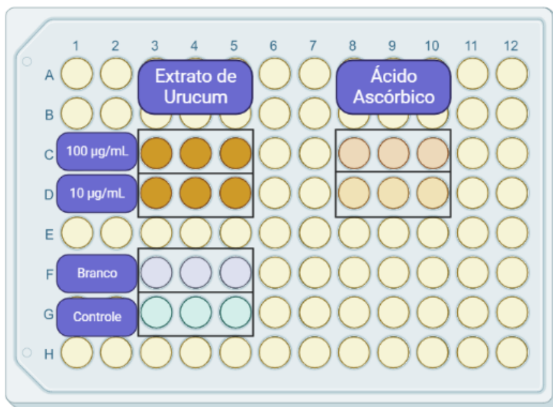
Figura 4.6. Esquema de alocação das amostras de Extrato de Urucum, Ácido Ascórbico, Metanol (Branco) e Solução de DPPH (Controle).
