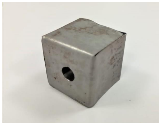
Figura 8.6 – “Cubo fechado” de ferro silício. Fonte: autor
