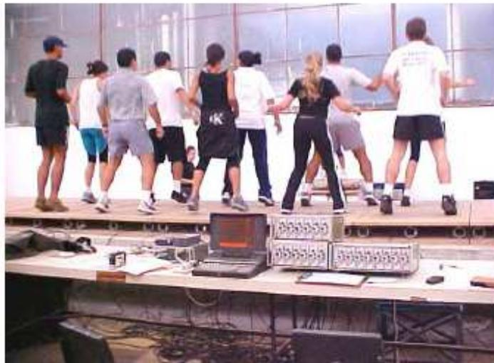
Figura 2.1 - Simulação do carregamento humano na plataforma experimental. (Fáisca, 2003).
