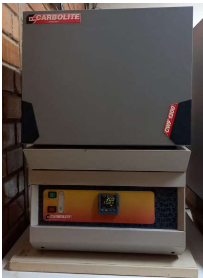
Figura 16: Forno de alta temperatura usado para tratamento térmico, em ar, dos filmes de CuO.
