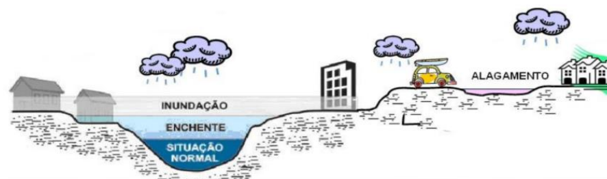
Figura 3.2 - Ocorrência de inundações, enchentes e alagamentos no meio urbano. (Fonte: CPRM, 2017)
