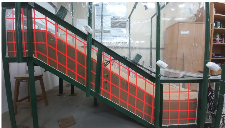
Figura 4.3: Equipamento de Simulação com o modelo reduzido de talude construído (Dantas, 2024).
