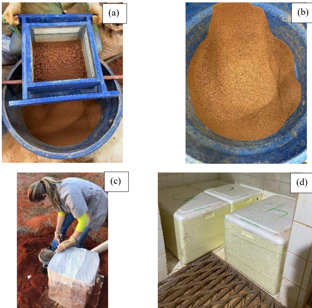
Figura 3.5 – Preparação para os ensaios (a) Peneiramento úmido (b) Amostra do solo laterítico após peneiramento (c) Amostra indeformada (d) Armazenamento
