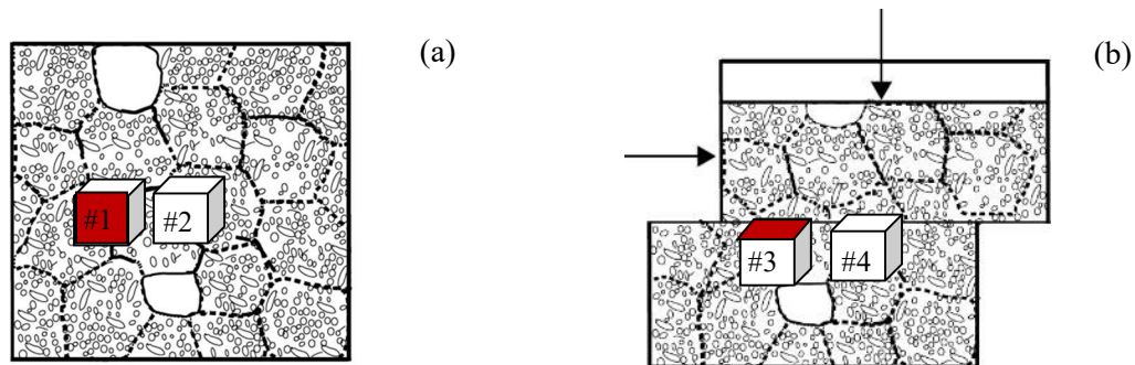
Figura 3.27 - Posição para extração das amostras. (a) Vista lateral antes do carregamento (b) Após cisalhamento. Para MEV: #1, #3. Para MIP: #2, #4.
