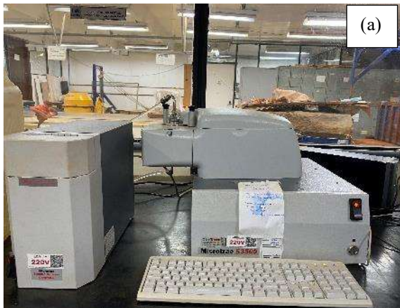
Figura 3.15 – (a) Granulômetro a laser (b) Amostra para ensaio de granulometria
