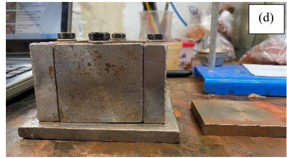
Figura 3.14 – Moldes para compactação semiestática (a) Base cilíndrica (b) molde e prensa (c) Molde quadrado (d) detalhe lateral molde quadrado
