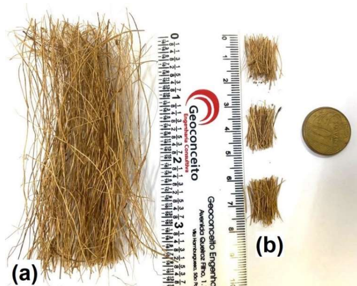
Figura 3.4 – (a) Fibras de Coco antes de cortadas. (b) Fibras de Coco com 15 mm de comprimento.
