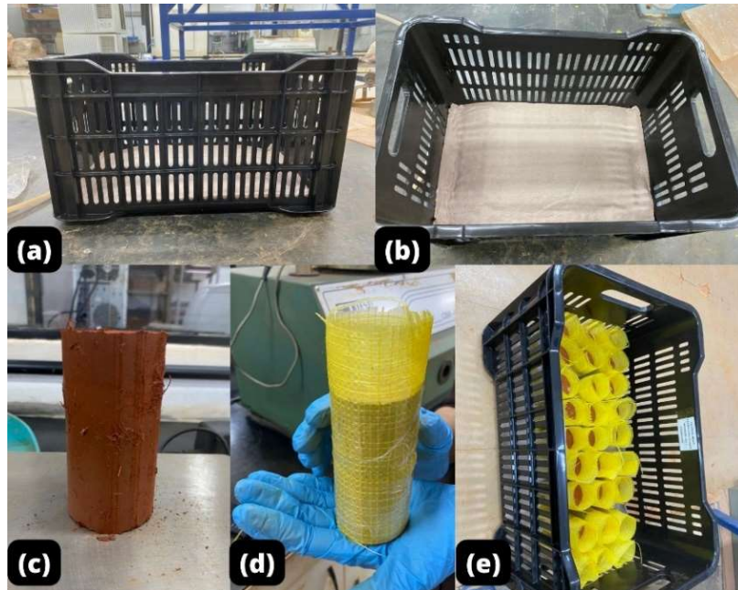
Figura 3.15 – (a) Caixas perfuradas. (b) Geotêxtil não tecido de proteção. (c) Corpo de prova compactado. (d) Corpo de prova embalado em lona plástica tecida. (e) Caixa contendo corpos de prova submetidos para degradação.
