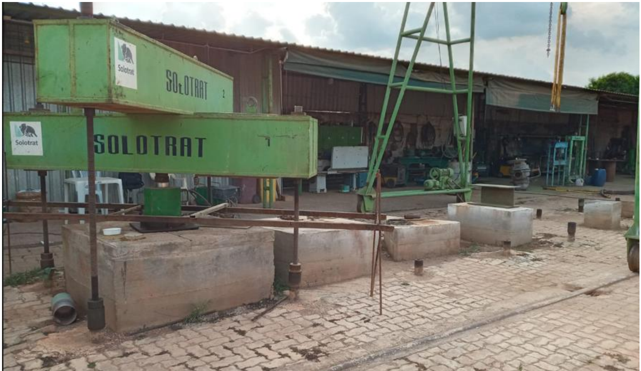
Figura 25. Equipamentos para se realizar a prova de carga do grupo de 5 estacas e a disposição dos outros grupos de estaca (estaca isolada, G_2 , G_3 , G_4 e G_5 ).
