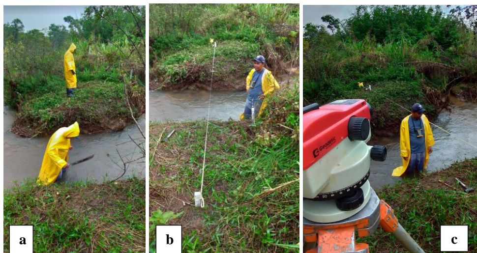
Figura 4 – Marcos cotados adotado no Ponto 02 – Córrego Pau de Caixeta. (a. Limpeza da margem, b. fixação dos marcos e c. nível topográfico para realizar as leituras).
