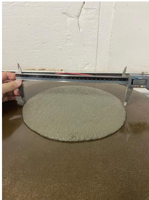
Figura 3.13 – Verificação do espalhamento do microconcreto na mesa de consistência.
