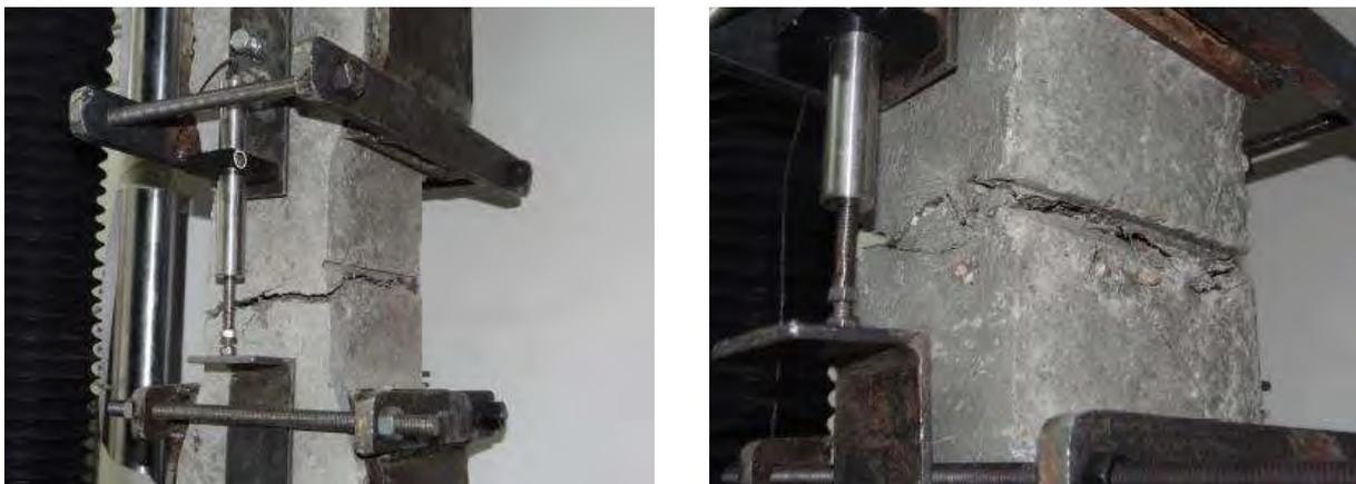
Figura 4.15 – Padrões de fissuração obtidos em laboratório (Baez, 2014).
