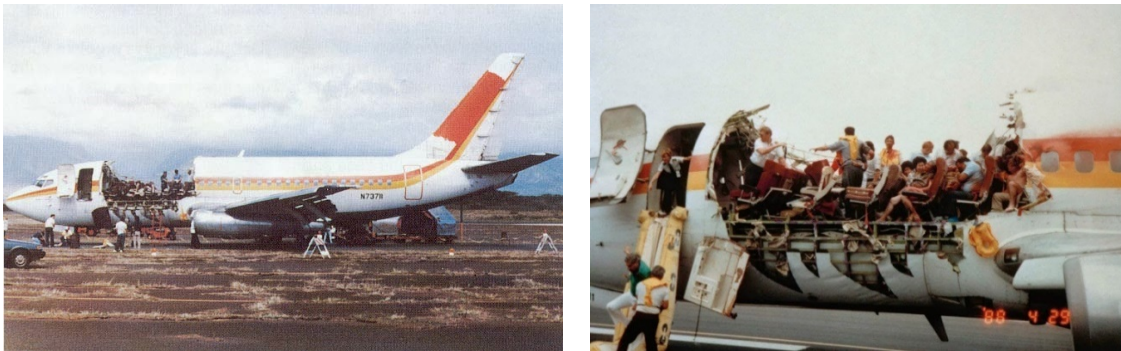
Figura 1.1 – Falha por fadiga da fuselagem do Boeing 737-200
