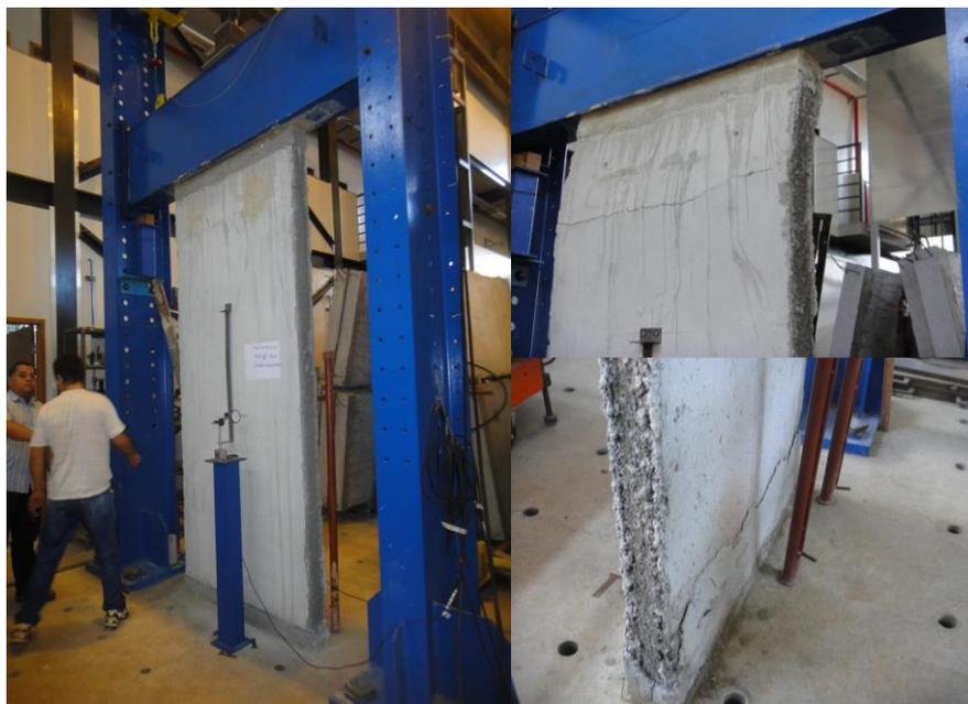
Figura 2.19 – Ensaio de compressão (Silva, 2013)
