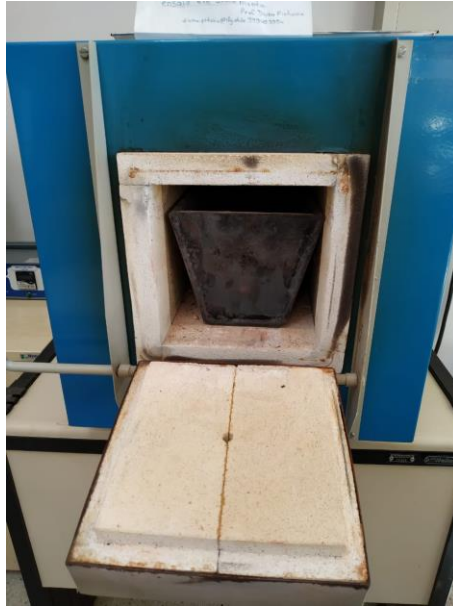
Figura 3-4: Recipiente e mufla utilizado na calcinação das amostras de argila.
