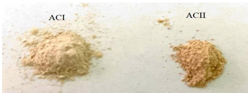
Figura 4-3: Coloração das amostras de argila calcinada devido ao teor de ferro.
