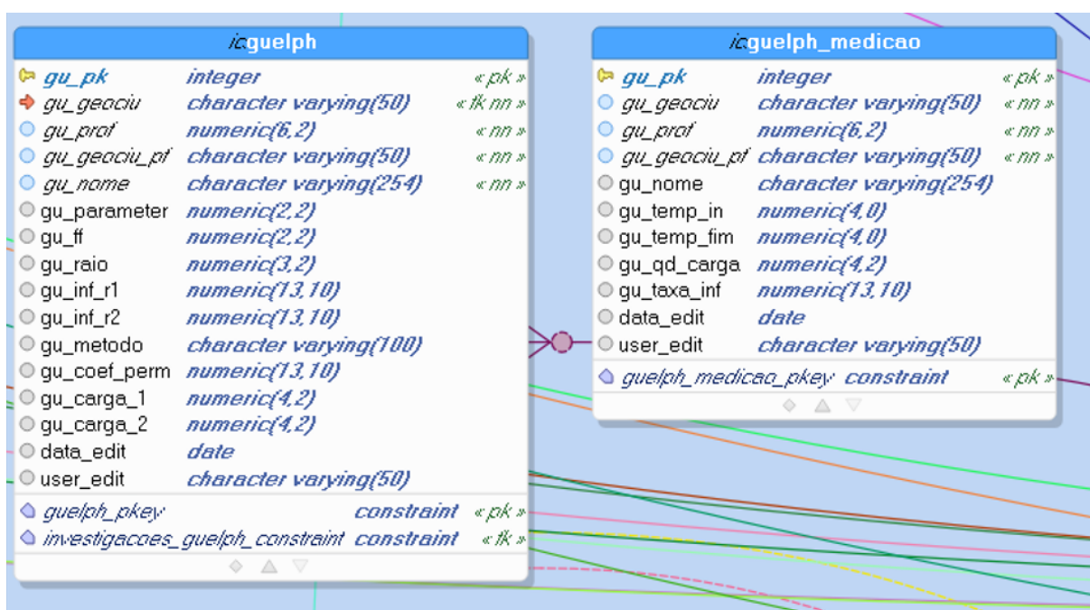
Figura 36: Recorte do esquema lógico apresentando uma tabela criada para armazenamento de dados brutos.
