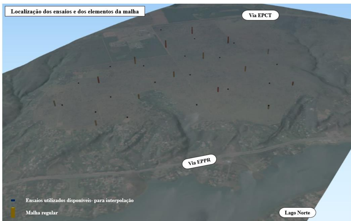
Figura 80: Distribuição espacial da malha interpolada em que os elementos da malha são representados pelos cilindros e as amostras pelos pontos simples
