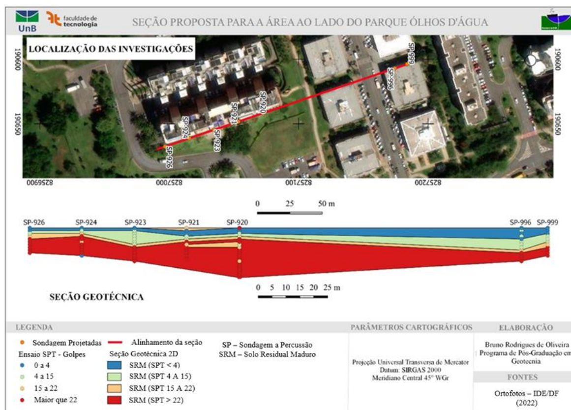
Figura 61: Seção traçada a partir das sondagens a percussão na área ao lado do parque olhos d'água.
