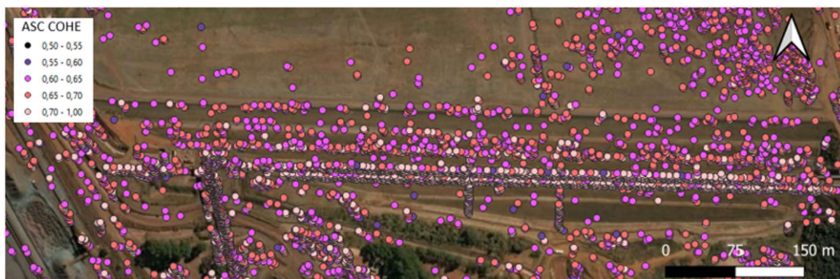
Figura 4-1 – Mapa de coerência dos dados da órbita ascendente (ASC) do monitoramento InSAR para a Barragem A.
