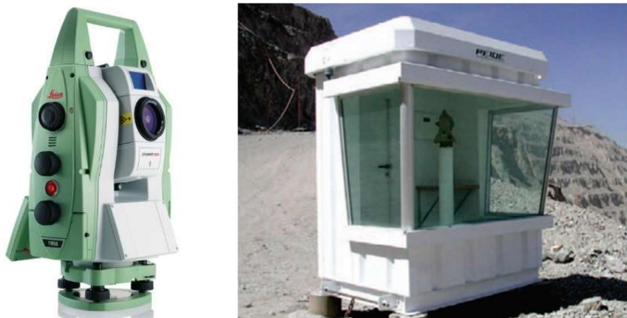
Figura 2-22 – Estação Total Robótica modelo TM50 (Leica Geosystem, 2023) e instalação em edificação de proteção posicionada em terreno estável (Hawley et al. , 2009).
