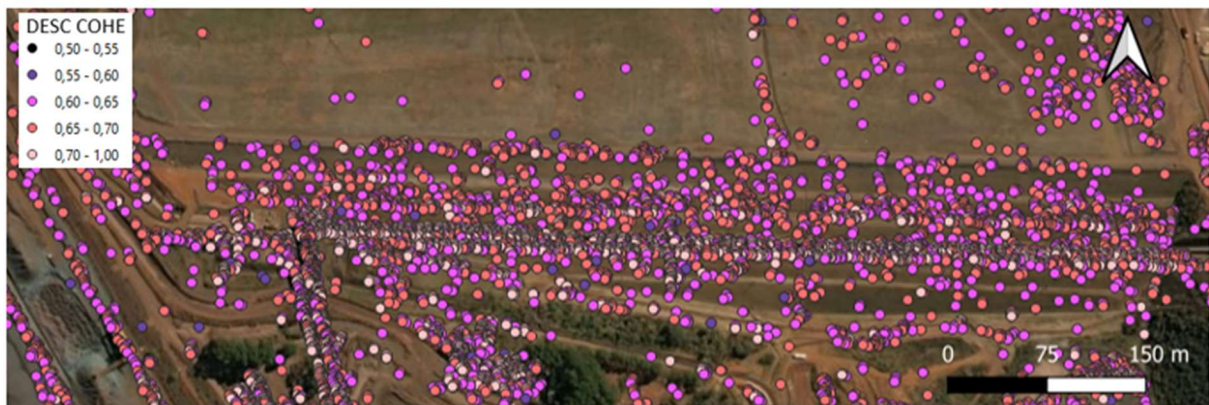
Figura 4-2 – Mapa de coerência dos dados da órbita descendente (DESC) do monitoramento InSAR para a Barragem A.
