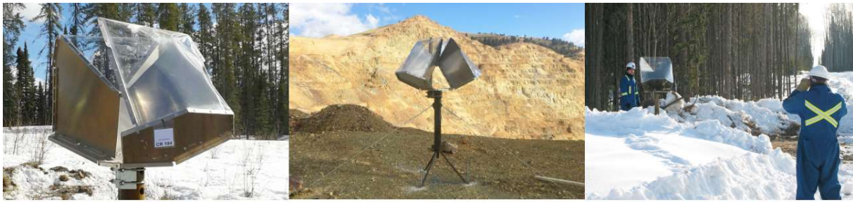
Figura 2-15 – Instalação do Corner Reflector em campo (TRE-ALTAMIRA, 2023b).
