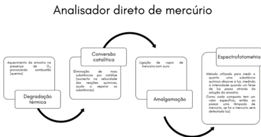
Figura 2 - Esquema explicativo das fases do funcionamento do analisador direto de mercúrio
