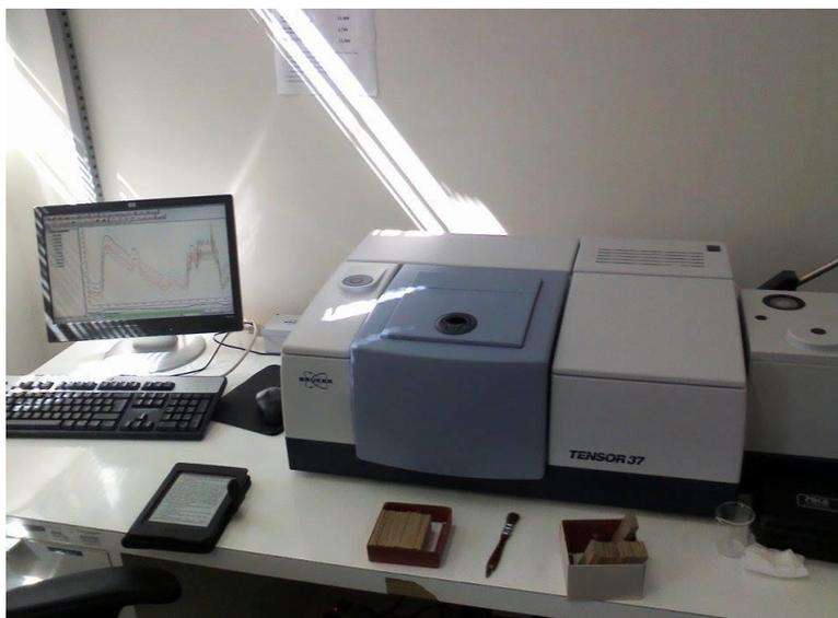
Figura 17. Espectrofotômetro TENSOR 37, marca Bruker.
