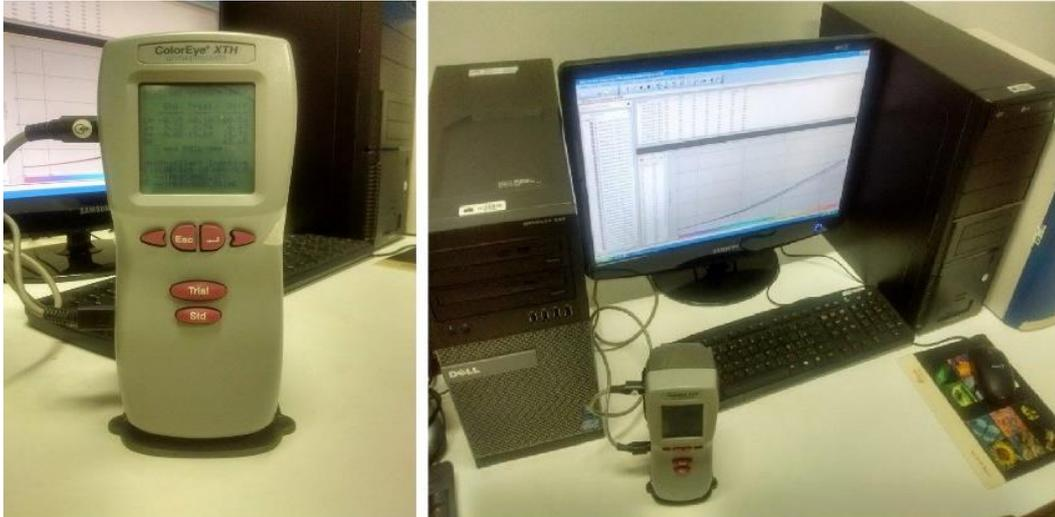
Figura 14. Espectrofotômetro ColorEye XTH marca X-Rite., com microcomputador acoplado.
