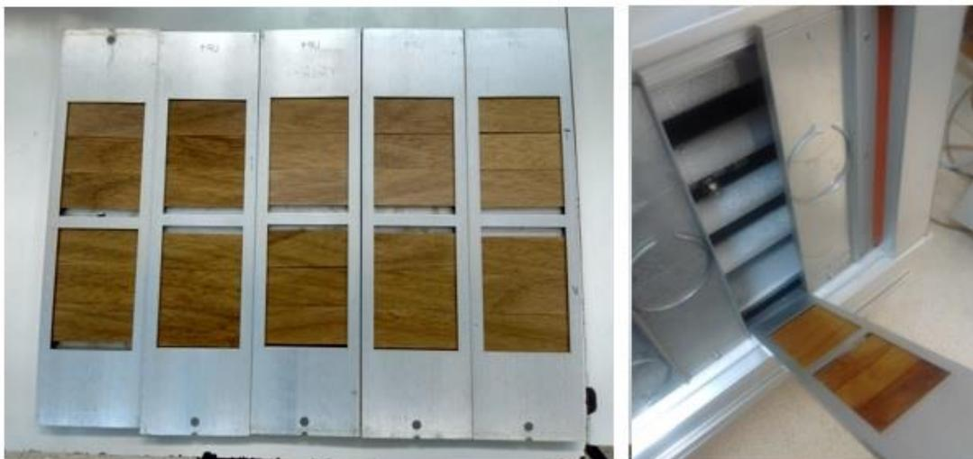
Figura 11. Esquema do ensaio de intemperismo em câmara de envelhecimento artificial.
