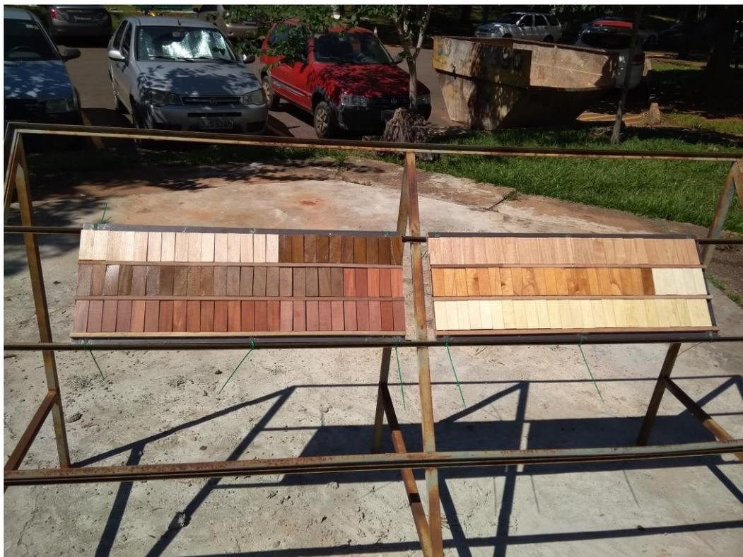
Figura 12. Stand de intemperismo natural, segundo a norma ASTM D1435.
