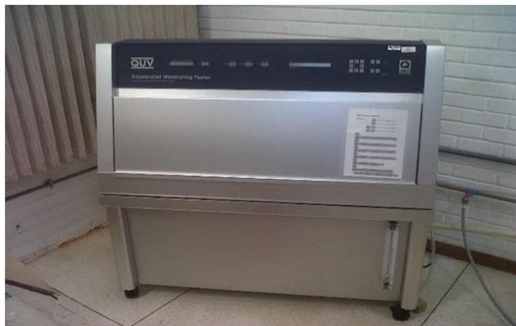
Figura 10. Equipamento de envelhecimento acelerado QUV/Spray.
