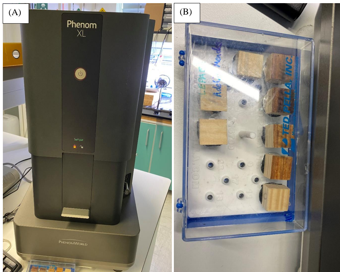
Figura 53. Microscópio PHENOM XL (A) e amostras de Pinus sylvestris preparadas para análise MEV (B).
