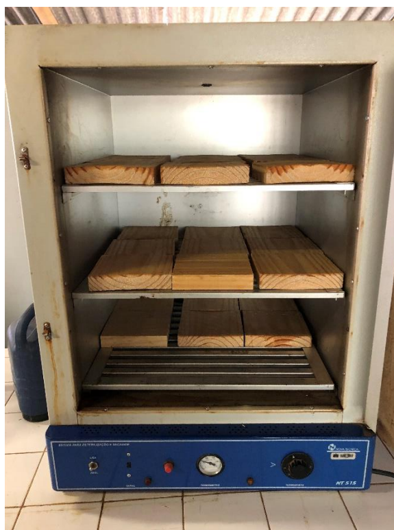
Figura 27. Acondicionamento das amostras em estufa para reação do ácido cítrico com a madeira.
