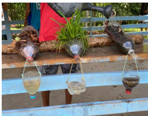
Figura 50 - Execução da experiência de proteção do solo
