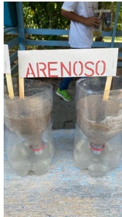
Figura 42 - Experiência de infiltração de água em diferentes solos IV
