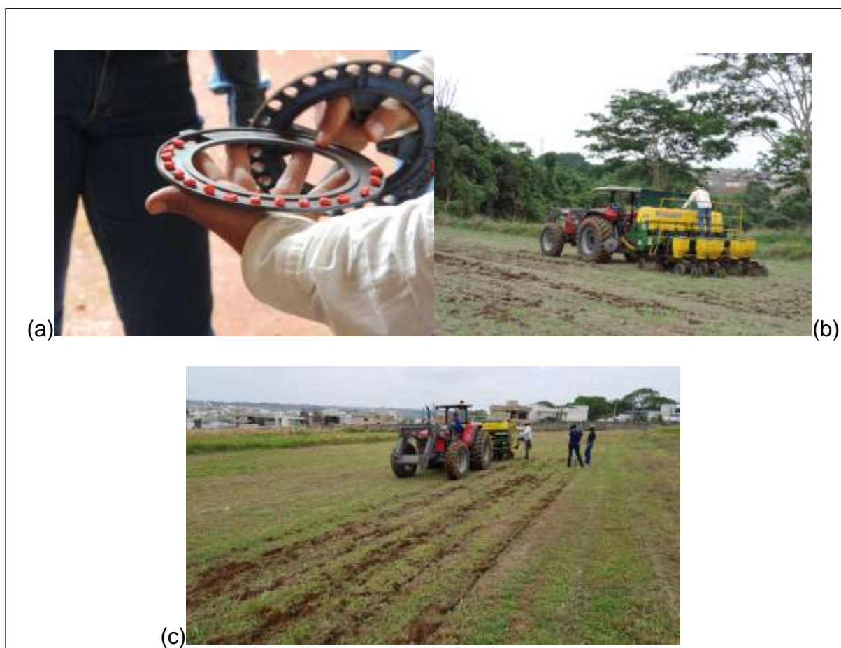
Figura 5. Plantio direto no solo. (a) Sementes de milho no disco da plantadeira; (b) Plantadeira realizando o plantio; e (c) Inspeção na plantadeira durante o plantio. – Fonte: Próprio Autor.
