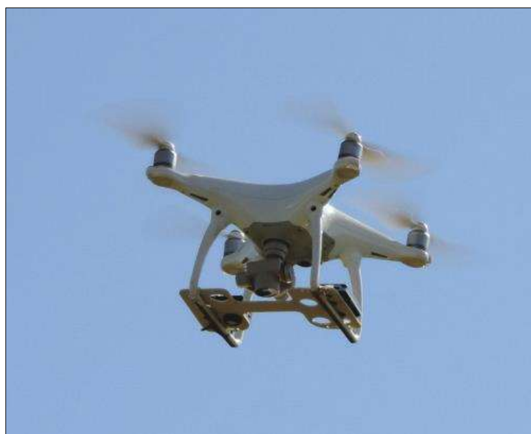
Figura 12. Câmera fotográfica digital da marca Mapir modelo Survey 2 embarcada no drone. Fonte: Próprio Autor.
