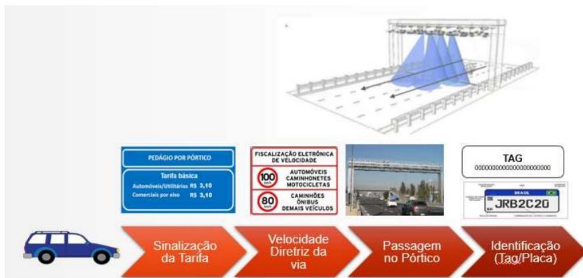
Figura 4.4 Fluxo de registro das passagens do sistema de cobrança free-flow
