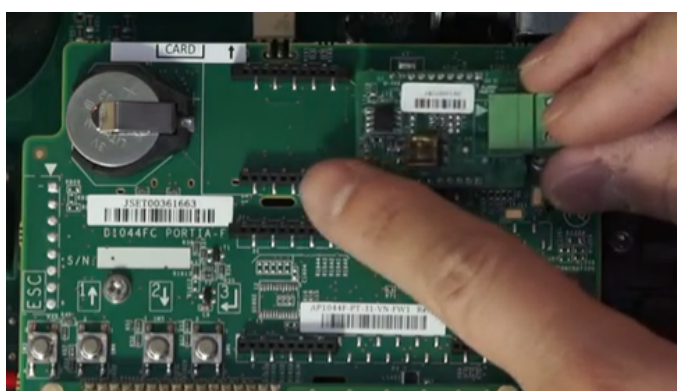
Figura 3.6: Instalação do Plugin na Placa Microcontrolada SE-SGM-R12-US-S
