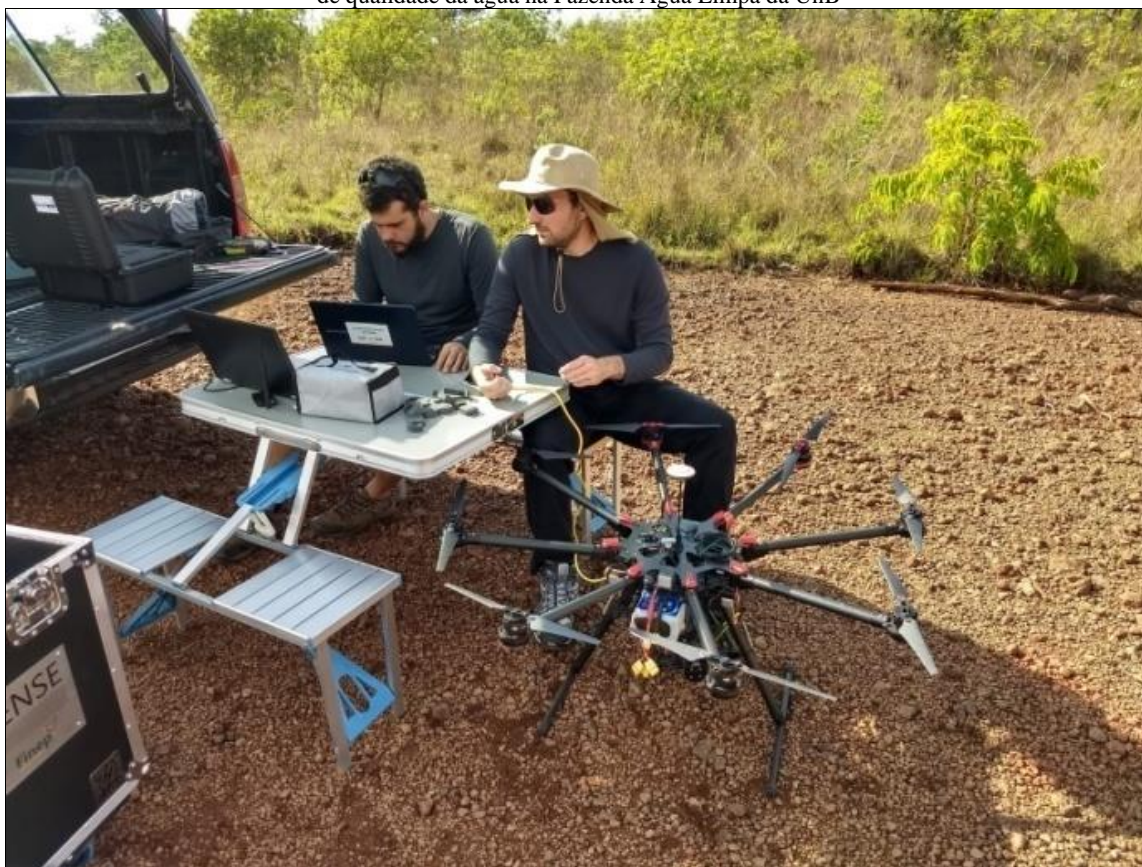
Figura 4- Alunos operando Drone DJI s1000 e câmera hiperespectral para monitoramento de qualidade da água na Fazenda Água Limpa da UnB
