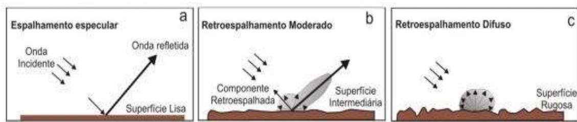
Figura 7 – Exemplos de rugosidade da superfície e sua interação com alvos. Fonte: Teixeira (2011).
