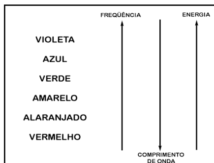
Fig. 7: relação cor – frequência – comprimento de onda – energia
