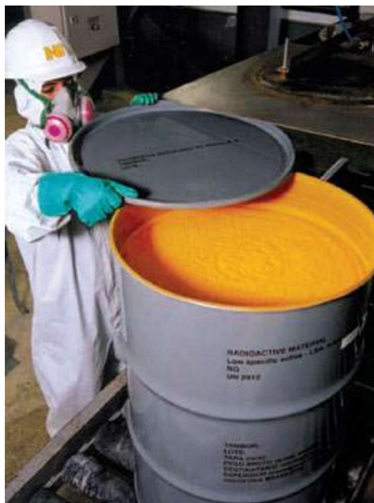
Figura 6 – funcionário da INB manuseando um barril de concentrado de urânio (pó) - yellow cake .
