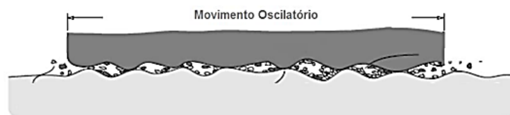
Figura 19 – Representação esquemática do desgaste por fretting [43] adaptado.
