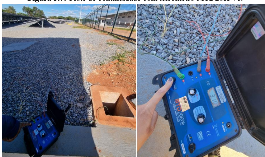
Figura 3.7. Teste de continuidade com terrômetro MTD20KWe.
