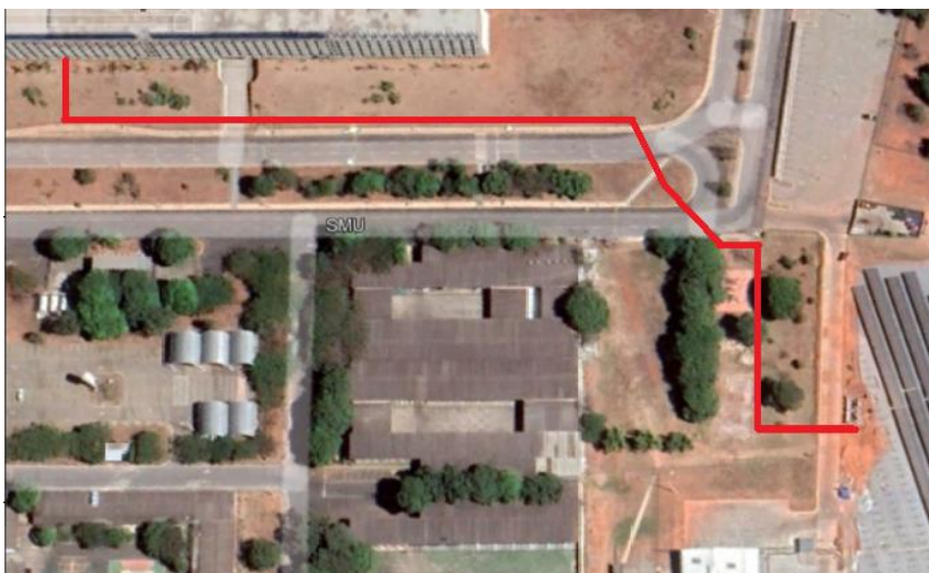
Figura 4.28. Traçado do cabeamento de média tensão.
