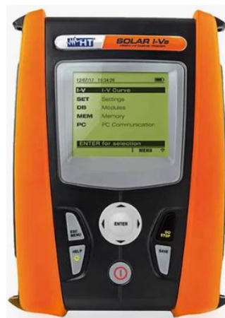
Figura 3.17. Equipamento caracterizador de curva I-V HT SOLAR I-Ve .
