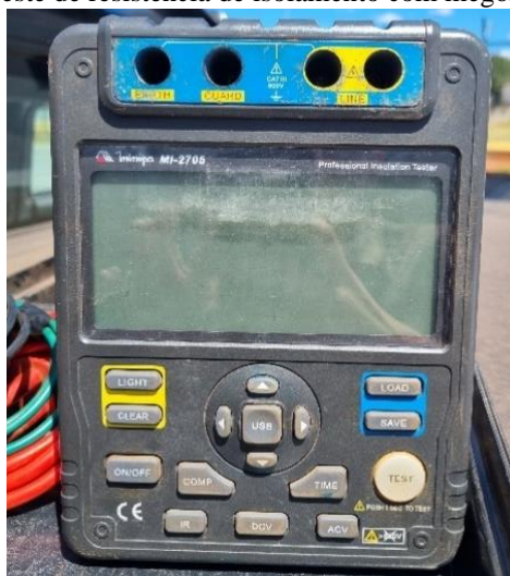
Figura 3.10. Teste de resistência de isolamento com megômetro Minipa MI-2705.
