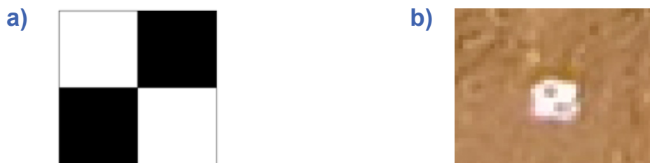
Figura 3.7 – a) tipo de alvo; b) visualização da fotografia com alvo de 4 x 4 pixels , voo a 120m e GSD de 5,3 cm com Phantom 4
