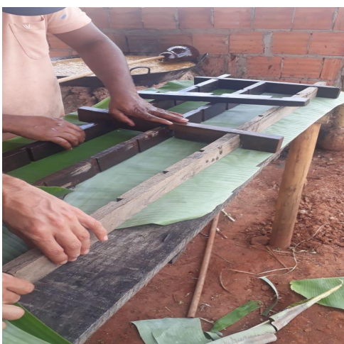
Figura A.2 – Montagem das formas de madeira de encaixe, forradas com folhas de bananeira
