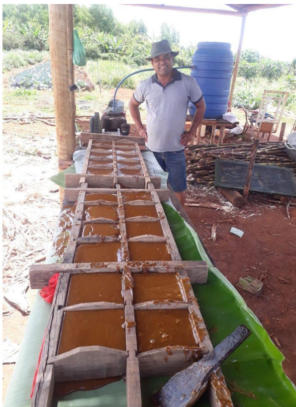
Figura A.3 – Produto distribuído nas formas de madeira de encaixe para finalizar o processo de produção da rapadura
