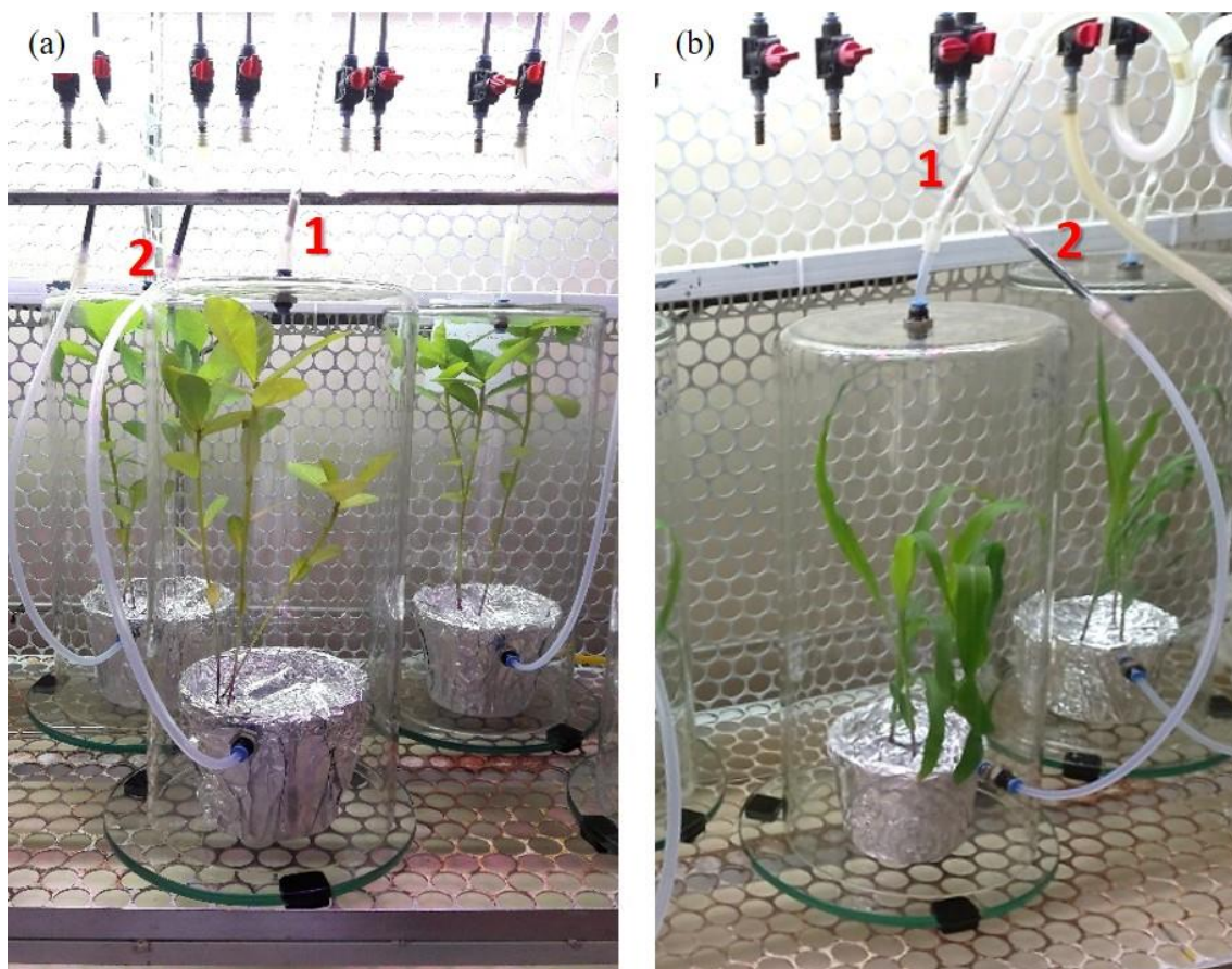
Figura 2. Sistema de aeração utilizado para a coleta dos compostos orgânicos voláteis das plantas de (a) Crotalaria spectabilis e de (b) milho (genótipo Sintético Spodoptera), em que 1 representa o tubo de vidro contendo o polímero adsorvente Porapak Q (por onde é feita a saída do ar), e 2 representa o filtro de carvão ativado conectado ao tubo de teflon e entrando na parte inferior da câmara, por onde ocorre a entrada de ar purificado (imagens pessoais).
