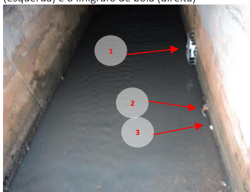
Figura 4.24. Ligação dos equipamentos na galeria: 1) boia acionadora do amostrador automático. 2) mangueira para coleta de amostras. 3) saída da tubulação de vaso comunicantes do linígrafo.
