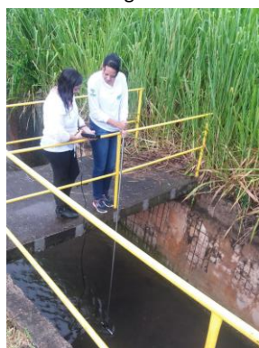
Figura 5.6. Medição de velocidade da água com o ADC.
