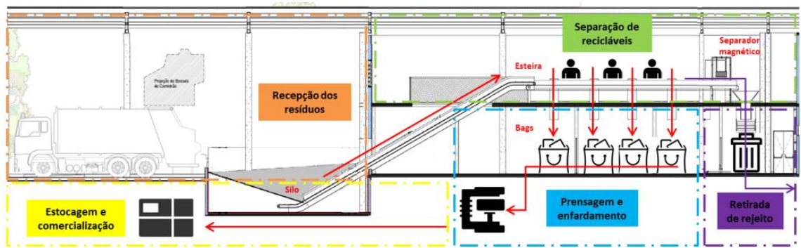
Figura 5.5 - Vista de perfil de uma IRR (centro de triagem).
