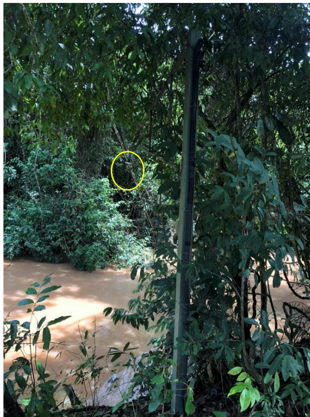
Figura 32. Sensor de medição do nível de água no rio Jardim. Fev/2020 - 15°58'22.07" / 47°24'29.23".
