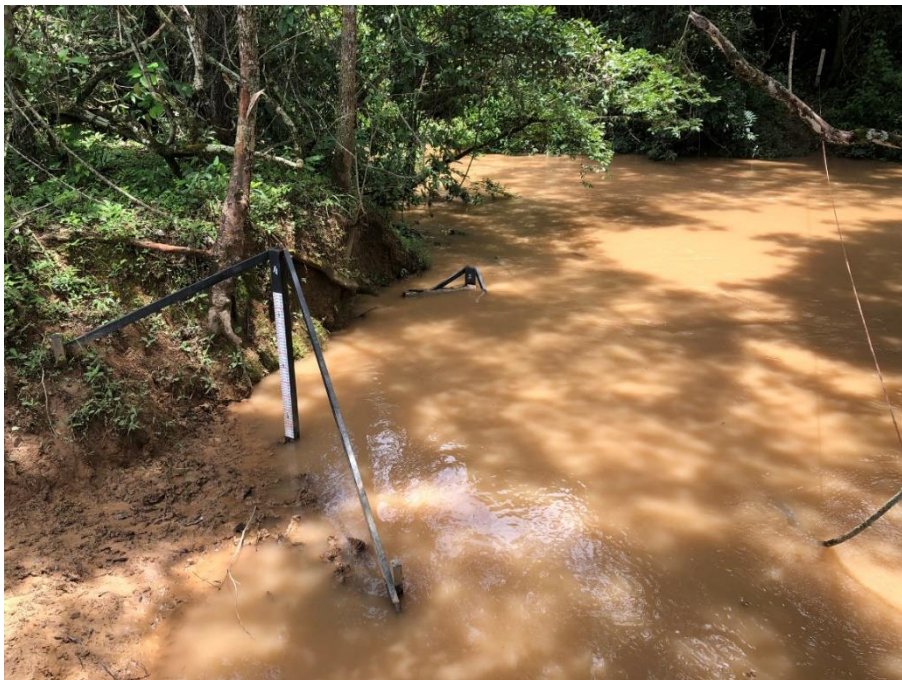
Figura 30. Régua linimétrica em trecho do rio Jardim. Fev/2020 – 15°58'22.38" / 47°24'29.35".
