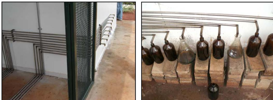
**Figura 19** Sistema de coleta das frações de destilação do produto craqueado. (Da ref. <sup>8</sup>).
