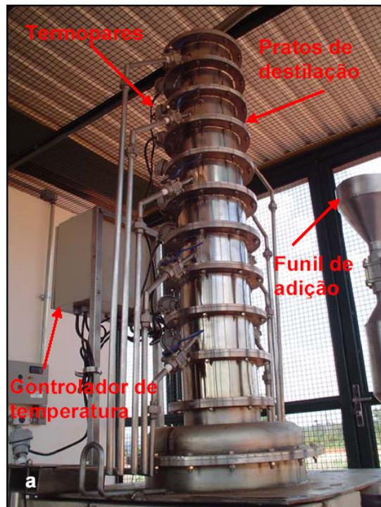
Figura 17 Foto do reator de craqueamento (Da ref. <sup>8</sup>).
