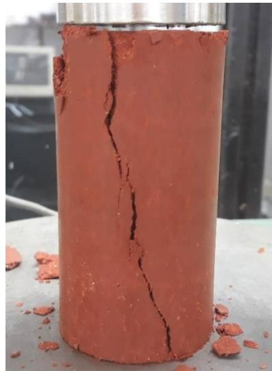
Figura 3.4 - Ruptura do corpo de prova após o ensaio de resistência à compressão simples.
